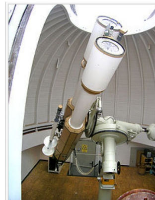
Dvojitý čočkový dalekohled používaný ke studiu Slunce na hvězdárně v Ondřejově
